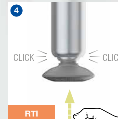
4 RTI Endstück mit Arretierung – fixiert Teleskop in Ruhestellung
